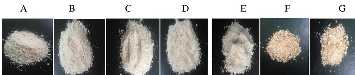
Gambar 1. Mikroskopik pati sukun (a) alami (b) hidrolisis HCl 5% 8 hari (c) hidrolisis HCl 5% 9 hari (d) hidrolisis HCl 6% 8 hari (e) hidrolisis HCl 6% 9 hari (f) hidrolisis HCl 7% 8 hari (g) hidrolisis HCl 7% 9 hari
